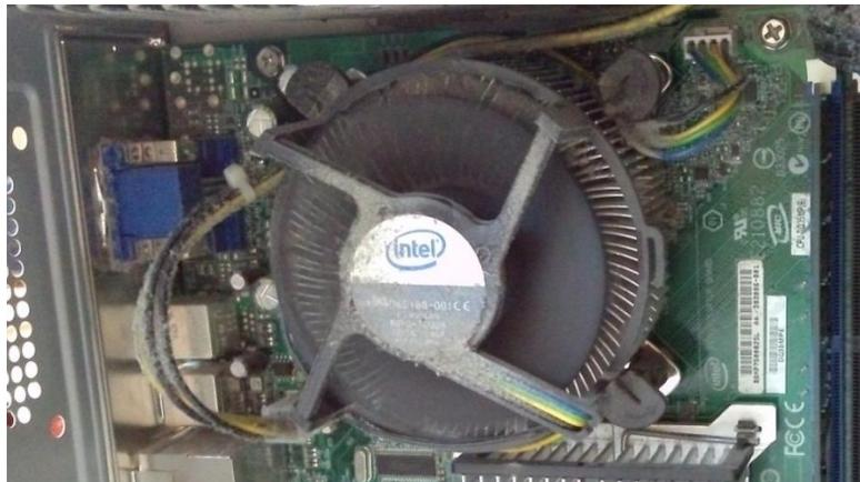
Wer nichts unternimmt riskiert, dass der Lüfter und auch andere Teile des Computers beschädigt werden. Je mehr Staub, desto mehr Wärme staut sich im Inneren Ihres PC's. Als Konsequenz drohen Leistungsabfälle oder sogar Systemabstürze. In extremen Fällen kann es auch zu Kurzschlüssen kommen.
